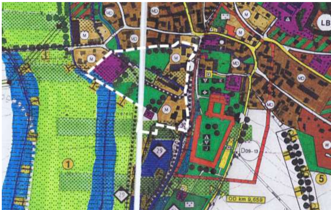
Ausschnitt aus dem rechtskräftigen Flächennutzungsplan Markt Thierhauptens mit Darstellung des Geltungsbereiches des neu geplanten Bebauungsplanes (weiß gestrichelt) o.M.
