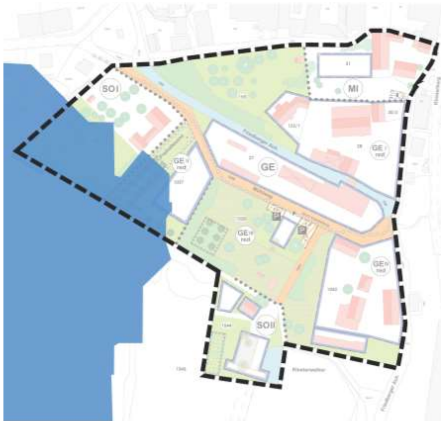
Abb. 10: Überschwemmungsbereich nach Fertigstellung (Bauabnahme) des Hochwasserrückhaltebeckens Quelle: WWA Donauwörth
