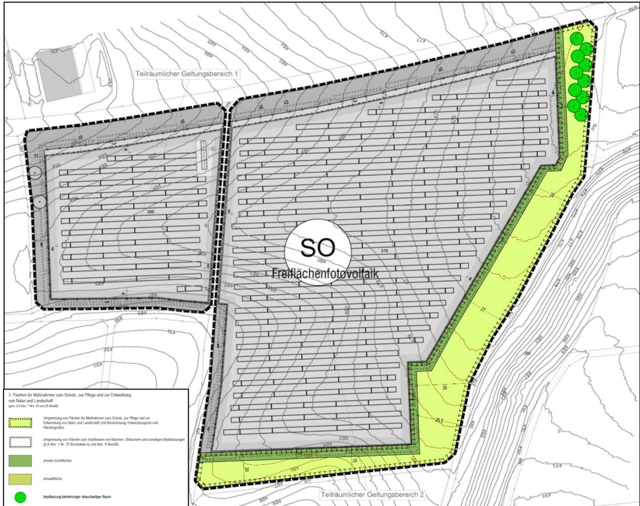
Abbildung 10: Freiflächenphotovoltaikanlage südlich der Kreisstraße A26, OT Neukirchen. Planzeichnung mit Ausgleichfläche, o. M.
