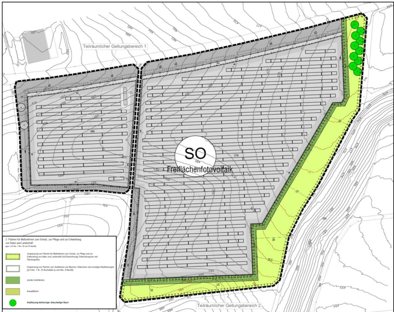
Abbildung 16: Freiflächenphotovoltaikanlage südlich der Kreisstraße A26, OT Neukirchen. Planzeichnung mit Ausgleichfläche, o. M.
